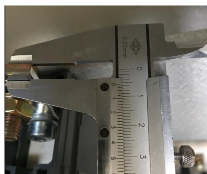
主开关进出线厚度照片
